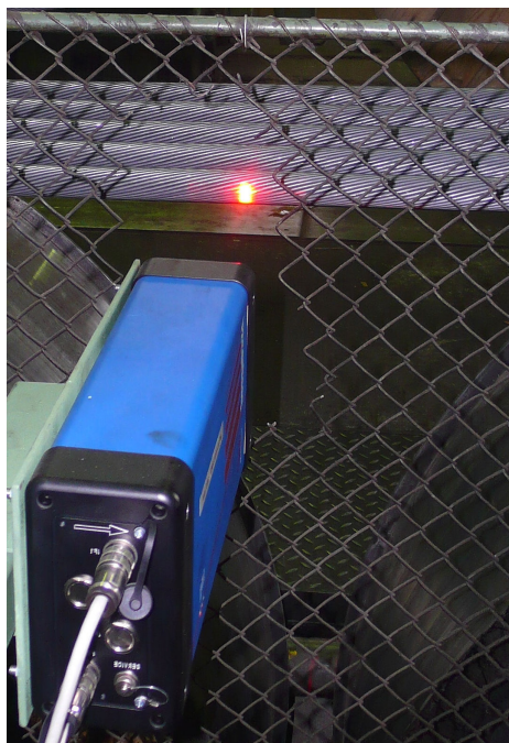
Bild 3 Geschwindigkeitsmessung an Drahtseilen
