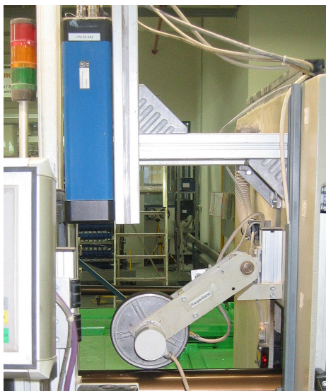
Bild 2 Schlupfmessung eines Laufrades
