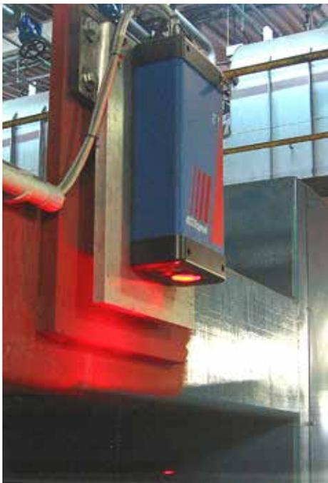
Bild1: Längenmessung im Prozessteil des Ofens 664
