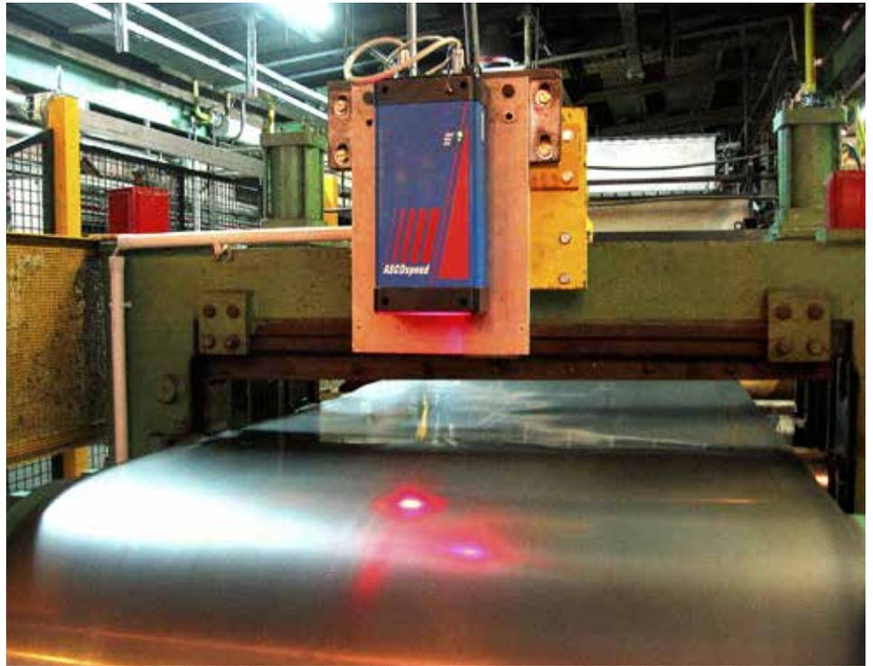
Geschwindigkeitsmessung am Einlauf eines Durchlaufofens
